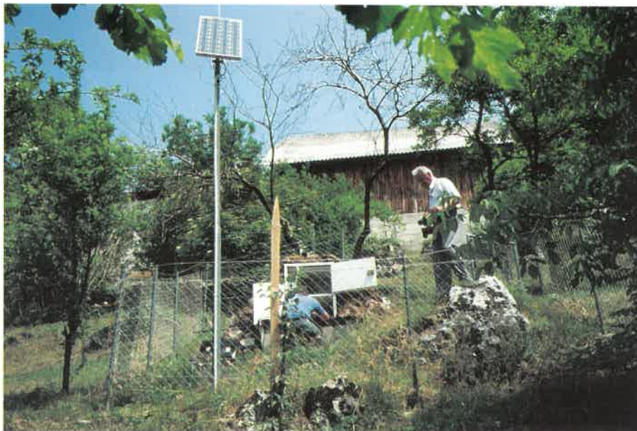
Slika 2. Potresna opazovalnica v Cesti pri Krškem je bila v letu 1997 posodobljena. Je edina opazovalnica v Sloveniji, ki se napaja z energijo iz sončnih celic (foto: R. Vidrih). Figure 2. Seismic station in Cesta near Krško was modernised in 1997. It is the only seismic station in Slovenia powered by solar cells (photo: R. Vidrih).
