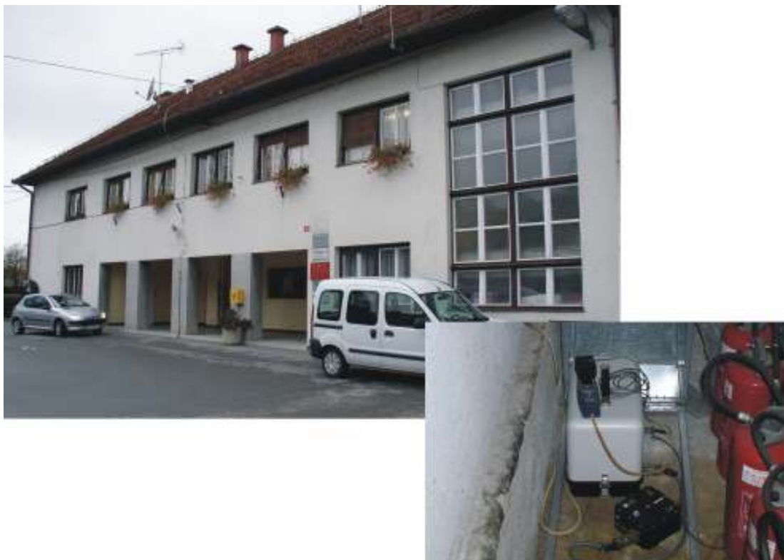
Slika 10. V Dolskem je akceleroграф SSA-2 nameščen v pritličju kulturnega doma. Figure 10. Accelerograph SSA-2 is installed in basement of cultural centre in Dolsko.
