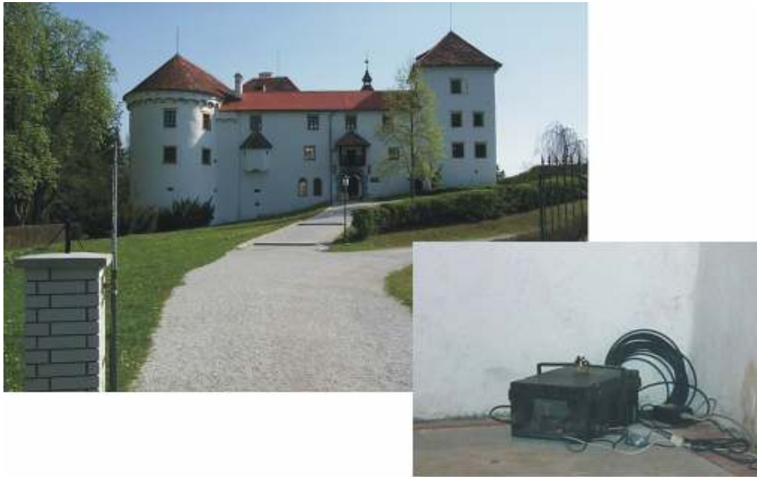
Slika 3. Na gradu Bogenšperk je v kleti nameščen akceleroграф Etna. Figure 3. Accelerograph Etna is placed in the cellar of the Bogenšperk castle.
