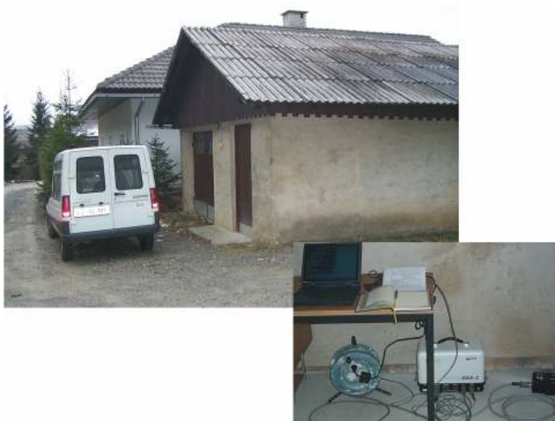
Slika 11. V Horjulu je akceleroграф SSA-2 nameščen v pomožnem objektu. Figure 11. Accelerograph SSA-2 is installed in auxiliary building in Horjul.
