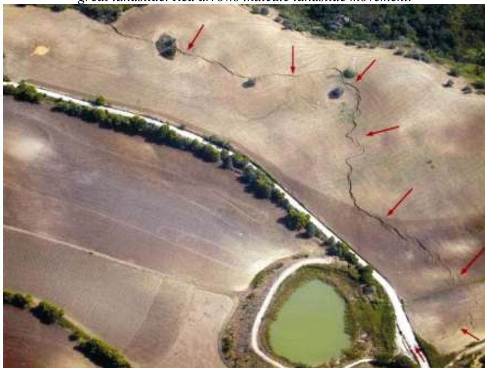
Slika 4. Detaljniji posnetek plazenja s smermi gibanja plazeče mase (plazine). Ob napajališču je prišlo do pretrga na cestišču, zamaknil pa se je tudi most.
