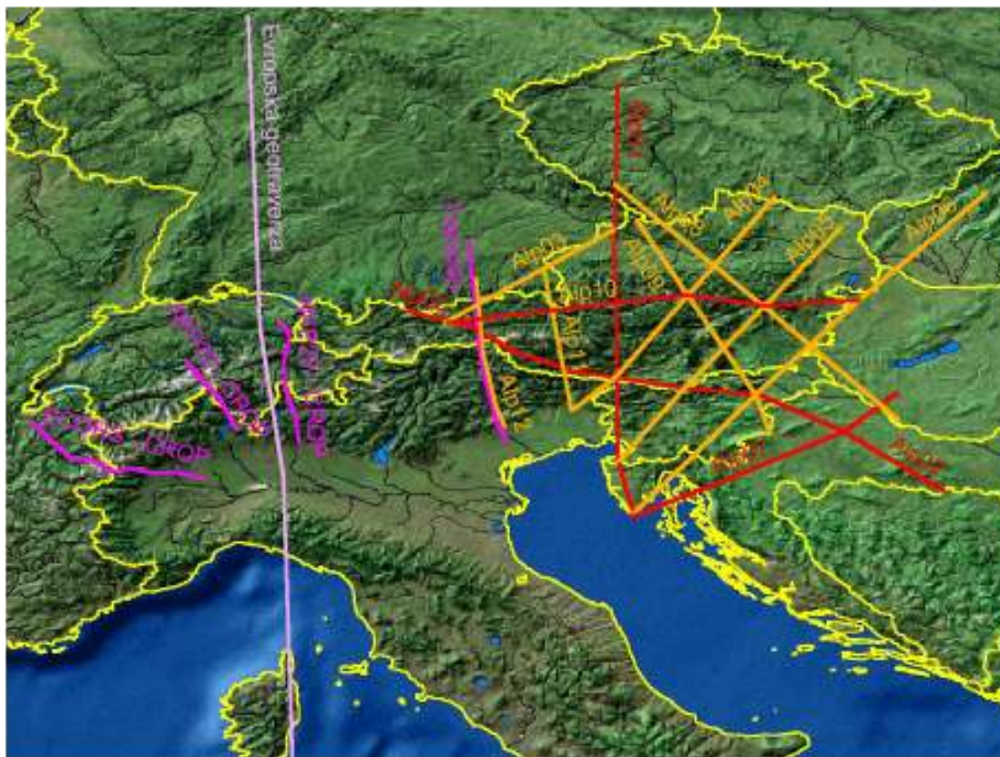
Slika 1. Položaj globokih seizmičnih profilov prek Zahodnih in Centralnih Alp (vijolična) in profilov, izmerjenih v okviru projekta Alp 2002. Profili gostejših meritev so rdeče, redkejših meritev pa oranžne barve.
