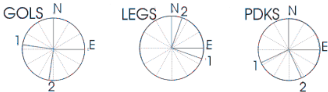
Slika 7. Zasuk senzorjev v vrtini glede na referenčni senzor
