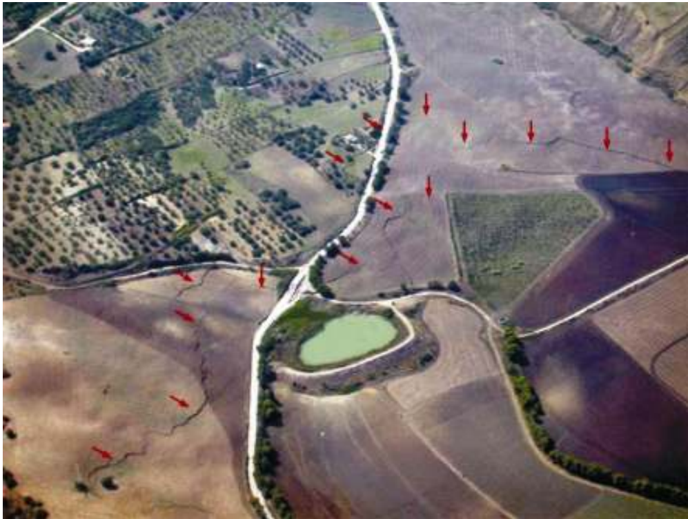
Slika 3. Letalski posnetek plazovitega območja v vasi Cerda kaže območje premikov velikega plazu. Z rdečimi puščicami je označena smer plazenja.
