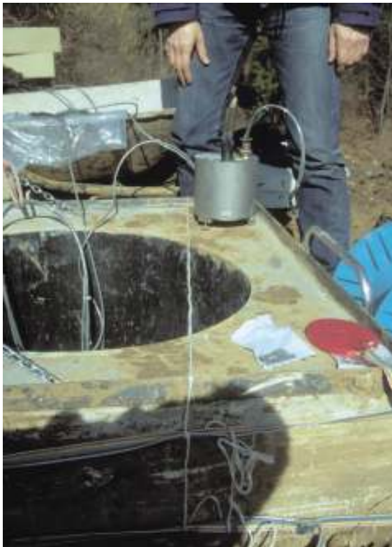
Slika 5. Referenčni senzor je postavljen na rob jaška
