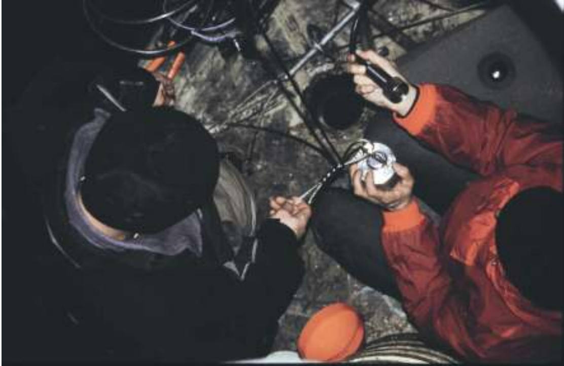
Slika 2. Pritrjevanje konektorja na seizmometer Figure 2. The connector is fastened to the seismometer
