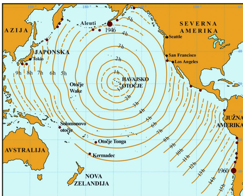
Slika 8. Trajanje potovanja cunamija po Tihem oceanu v primeru potresa na Havajih. Lahko ocenimo, koliko časa rabijo valovi, da prepotujejo Tih ocean.
