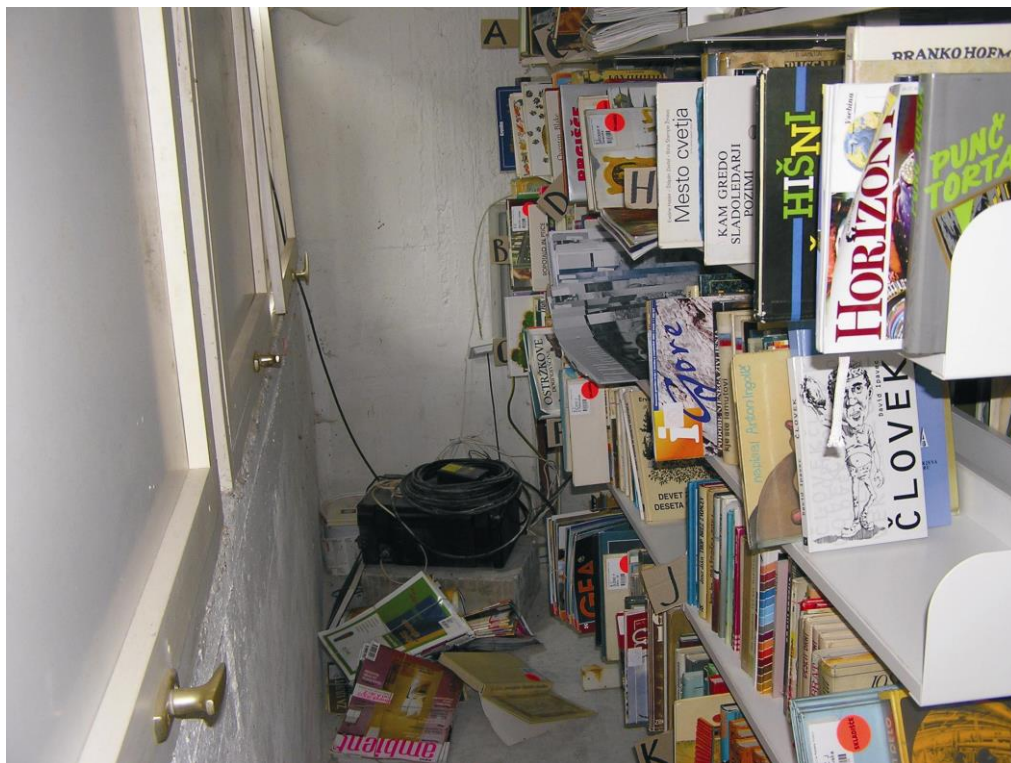
Slika 1. Pospeškometer v bovški knjižnici po potresu 12. 7. 2004. Poleg instrumenta ležijo knjige, ki so padle s polic med potresom.
