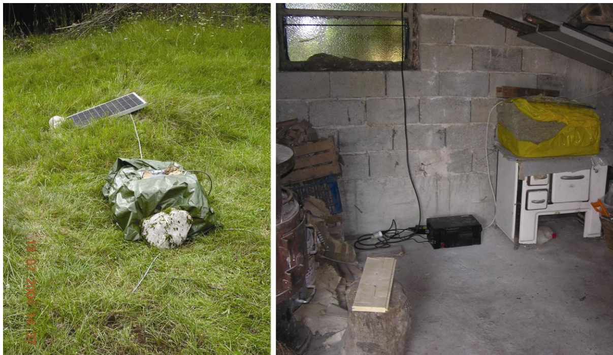
Slika 2. Levo: postavoitev začasne potresne opazovalnice na polju (INGV). Desno: postavoitev v zgradbi (Fejnerjev hlev, DST).
