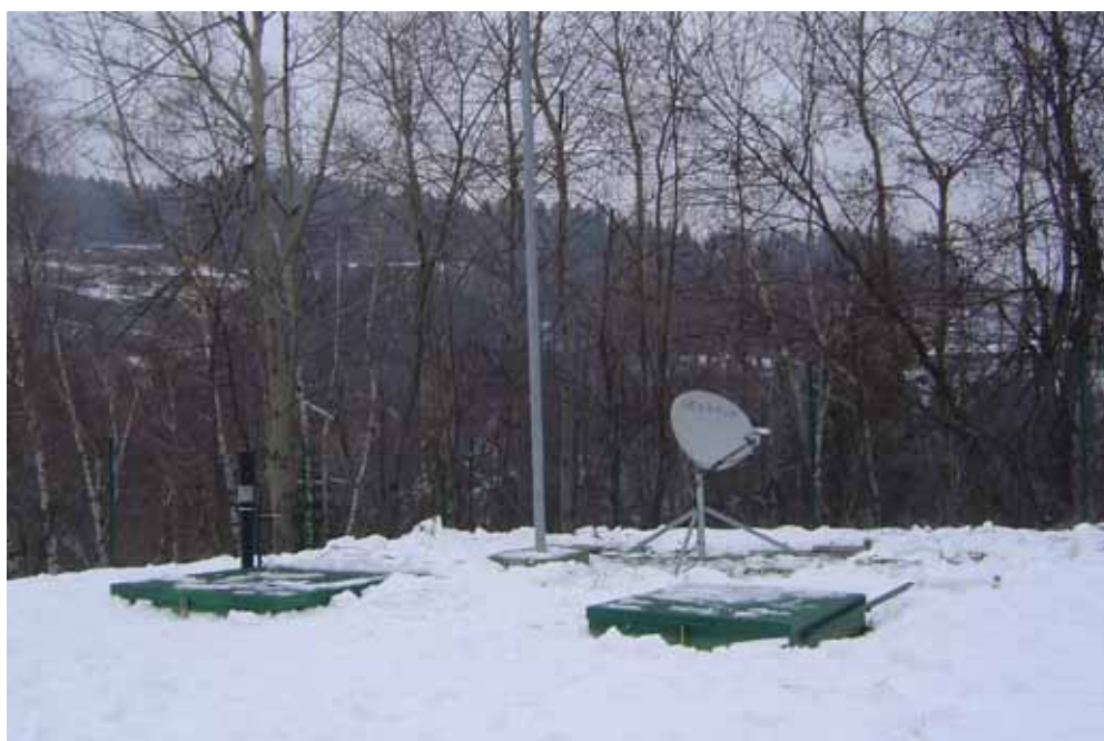
Slika 3. Nova potresna opazovalnica na Črnem Vrhu nad Polhovim Gradcem (CRNS) z začasno postavljeno satelitsko anteno za prenos podatkov po satelitskem internetu. Figure 3. New seismic station on Črni Vrh above Polhov Gradec (CRNS) with temporary installed satellite antenna for data transmission over satellite internet.
