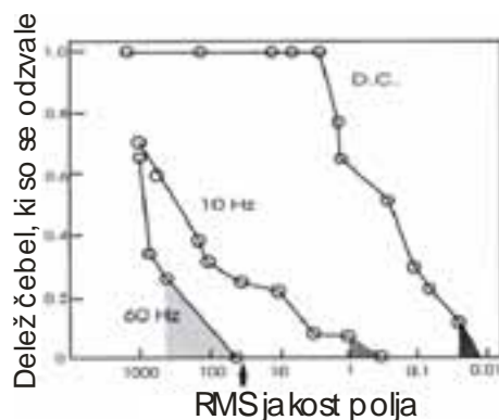
Slika 7. Meritve sposobnosti čebel, da razlikujejo magnetne signale različnih frekvenc. Magnetorepcija čebel je uglašena na frekvence pod 10 Hz.
