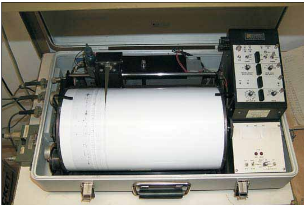
Slika 28. Prenosni enokomponentni pisar PS-2 z vgrajenim seizmografskim ojačevalnikom.
