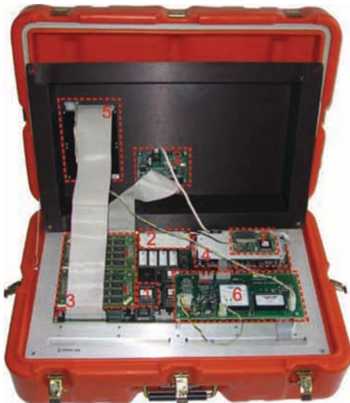
Slika 1. Quanterra Q730: Z rdečo črtkano črto so obrobjene enote, kjer so se pojavile posamezne okvare: PLD-ROM (1), mrežne kartice (2), pomnilniške kartice (3), TERM vrata (4), disk (5) in enosmerna napajalna plošča (6).
