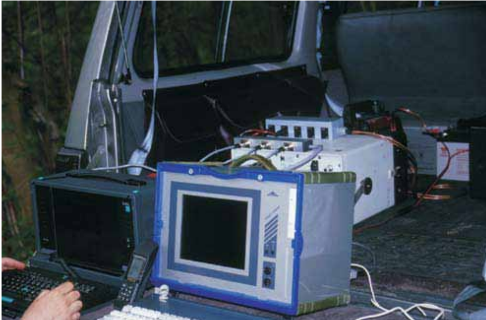
Slika 32. Terenske meritve seizmičnega nemira z instrumentom SSR-1.
