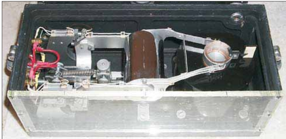
Slika 17. Seizmometer Vegik je sestavni del seizmografa za predhodno določanje časa prihoda primarnih in sekundarnih valov ob povečanem seizmičnem nemiru.
