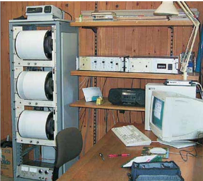
Slika 26. Pisači VR-2 so v kovinskem ohišju; na srednji polici so seizmografskimi ojačevalniki SO-03, ura UK-03 in dolgovalovni sprejemnik časovnih signalov DS-02; na spodnji polici je stabilizirani usmernik (potresna opazovalnica Vojsko).
