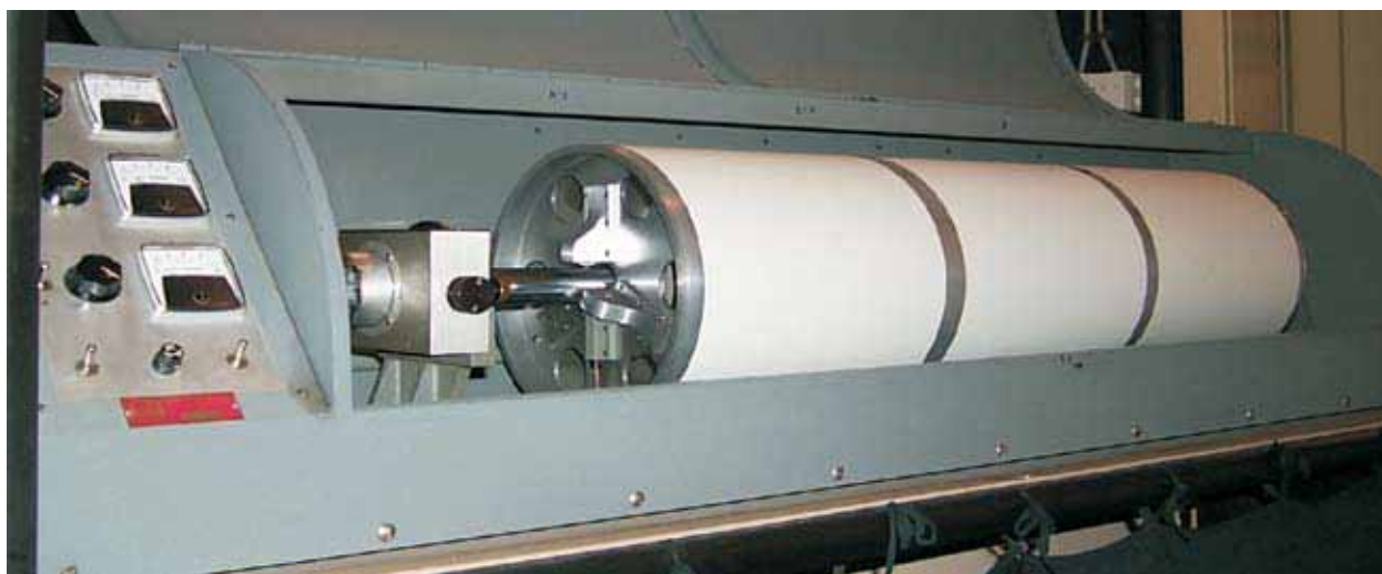
Slika 12. Registrirni valj R-6007 s tremi listi 90 x 30 cm velikega fotografskega papirja za vertikalno in obe horizontalni komponenti; kovinski pokrov preprečuje nenadno osvetlitev papirja; dolžina minute je nastavljiva: 15, 30 ali 60 mm.
