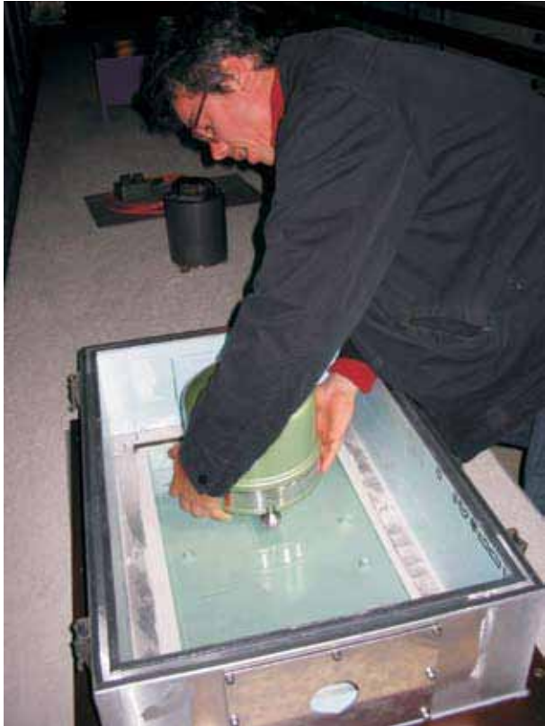
Slika 4. Instalacija seizmometra STS-2. V ozadju je seizmometer CMG-3ESPC.
