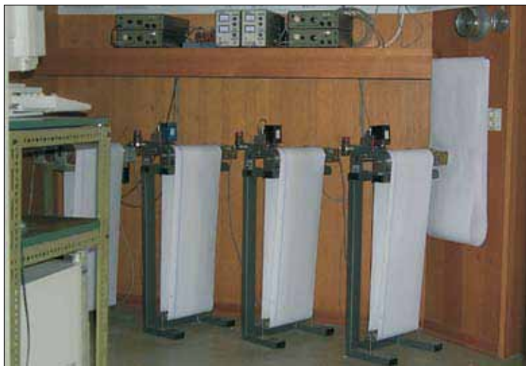
Slika 15. Pisači Günter-Volk zapisujejo s črnilom na 180 cm dolg papir; na polici nad pisachi so seizmografski ojačevalniki SO-01 in napajalniki.
