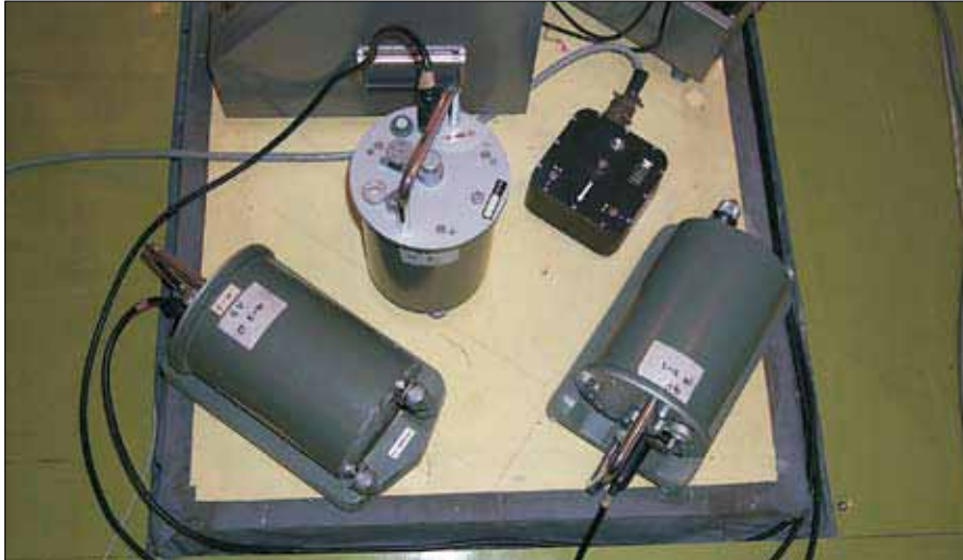
Slika 14. Seizmometri Willmore MkII, postavljeni na stebru v kleti observatorija na Golovcu v Ljubljani.
