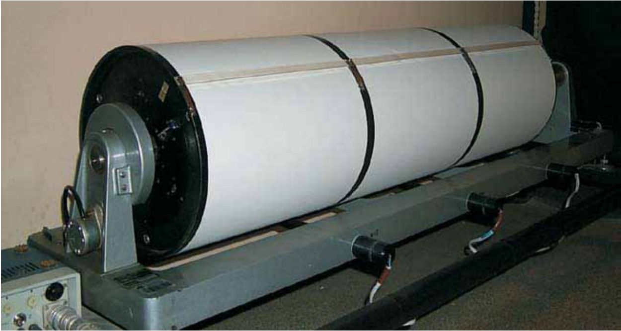
Slika 9. Registrirni valj DR-273 s tremi listi 90 x 30 cm velikega fotografskega papirja za vertikalno in obe horizontalni komponenti; dolžina minute je 60 mm.
