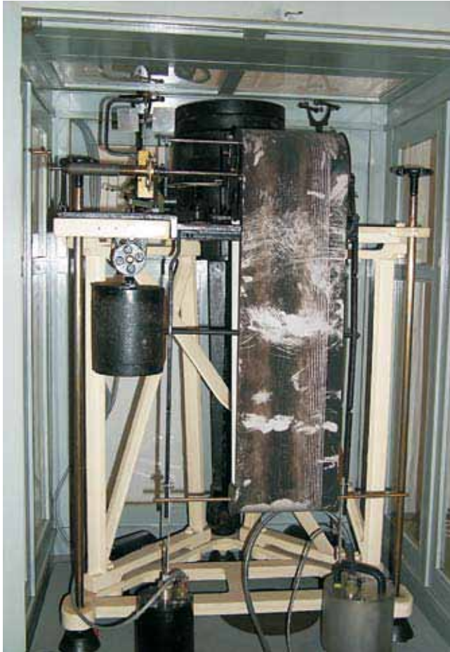
Slika 3. Seizmograf Wiechert v kleti observatorija na Golovcu v Ljubljani; stoji na posebnem stebru in je shranjen v stekleni vitrini; seizmograf je še vedno usposobljen za uporabo, vendar se zaradi zamudne priprave osajenega papirja ne uporablja več.
