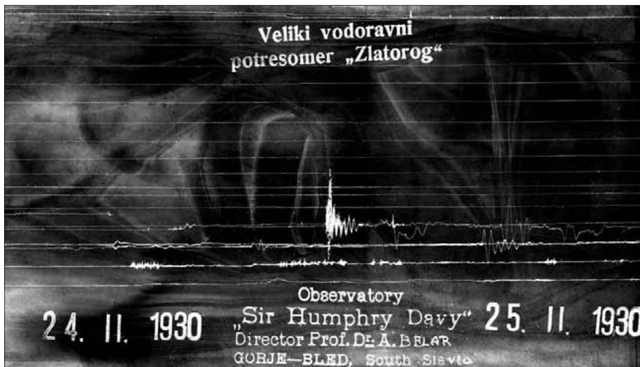
Slika 2. Zapis lokalnega potresa 24. februarja 1930 ob 13. uri in 35 minut po UTC na Belarjevem seizmografu Zlatorog; seizmograf je bil postavljen v Belarjevem zasebnem observatoriju v Podhomu pri Bledu; deloval je v obdobju 1902-1919 na realki v Ljubljani in v letih 1924-1930 v zasebnem observatoriju A. Belarja v Podhomu pri Bledu; zapis je bil na osajenem papirju, namenjen pa je bil zapisovanju bližnjih potresov.
