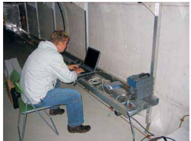
Slika 7. Nastavitve parametrov na zajemalni enoti Earthdata PR-6.
