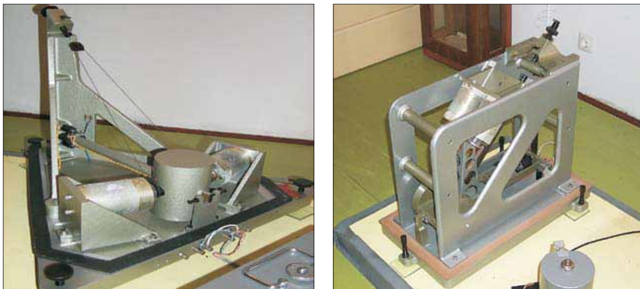
Slika 11. Dolgoperiodni horizontalni seizmometer S-5007-H (levo - cilindrična 10,7 kilogramska utež je pritrjena na vodoravno palico in podprta z žičnim jarmom) in vertikalni S-5007-V (desno).
