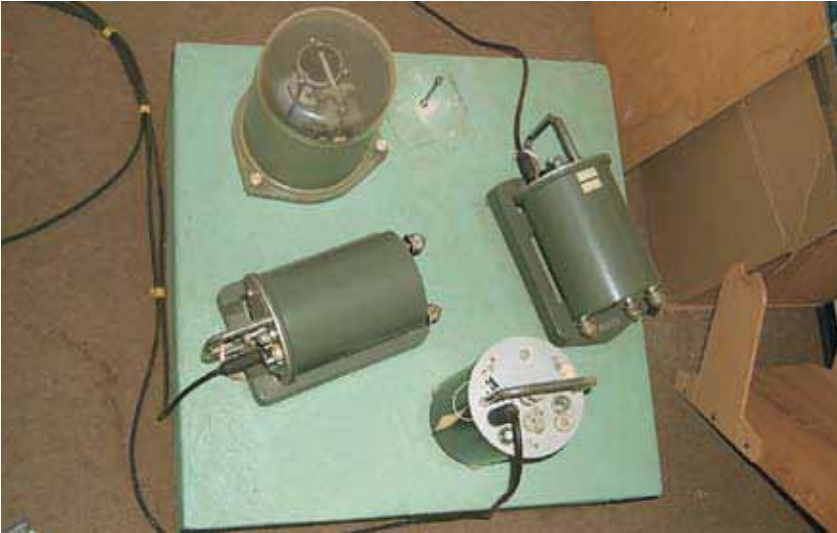
Slika 25. Seizmometri Willmore MkII na stebru na opazovalnici v Cerknici.
