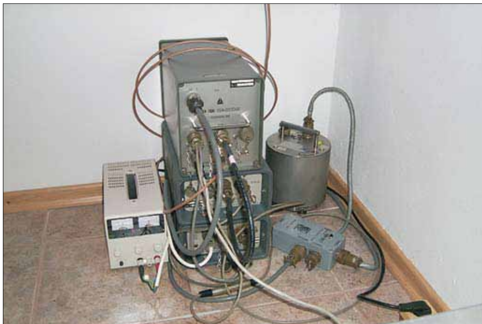
Slika 33. Začasna postavitve seizmografa Reftek 72A-07/DSK za beleženje popotresne aktivnosti v Posočju.
