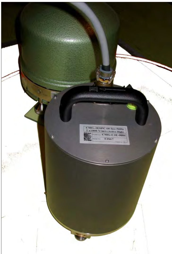
Slika 1. Seizmometer CMG-3ESPC, v ozadju je seizmometer STS2.
