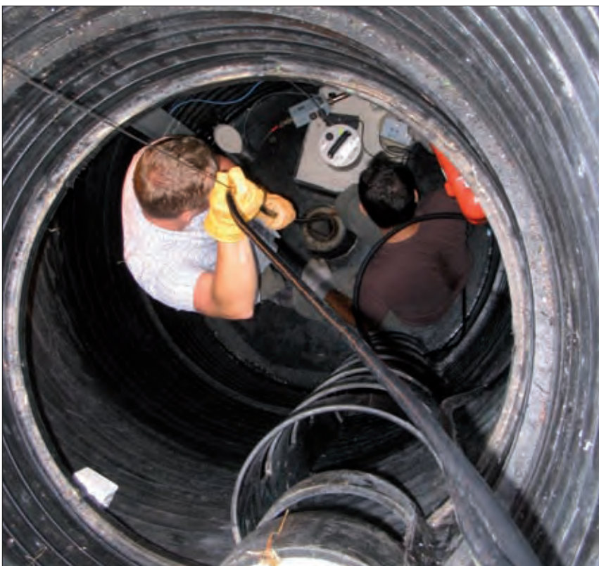
Slika 1. Namestitvev seizmometra v vrtino v fazi niveliranja seizmometra s pomočjo vgrajenega inklinometra. Na betonskem podstavku je viden tudi seizmometer CMG-40T, ki smo ga uporabili za določitev usmeritve seizmometra v vrtini.
