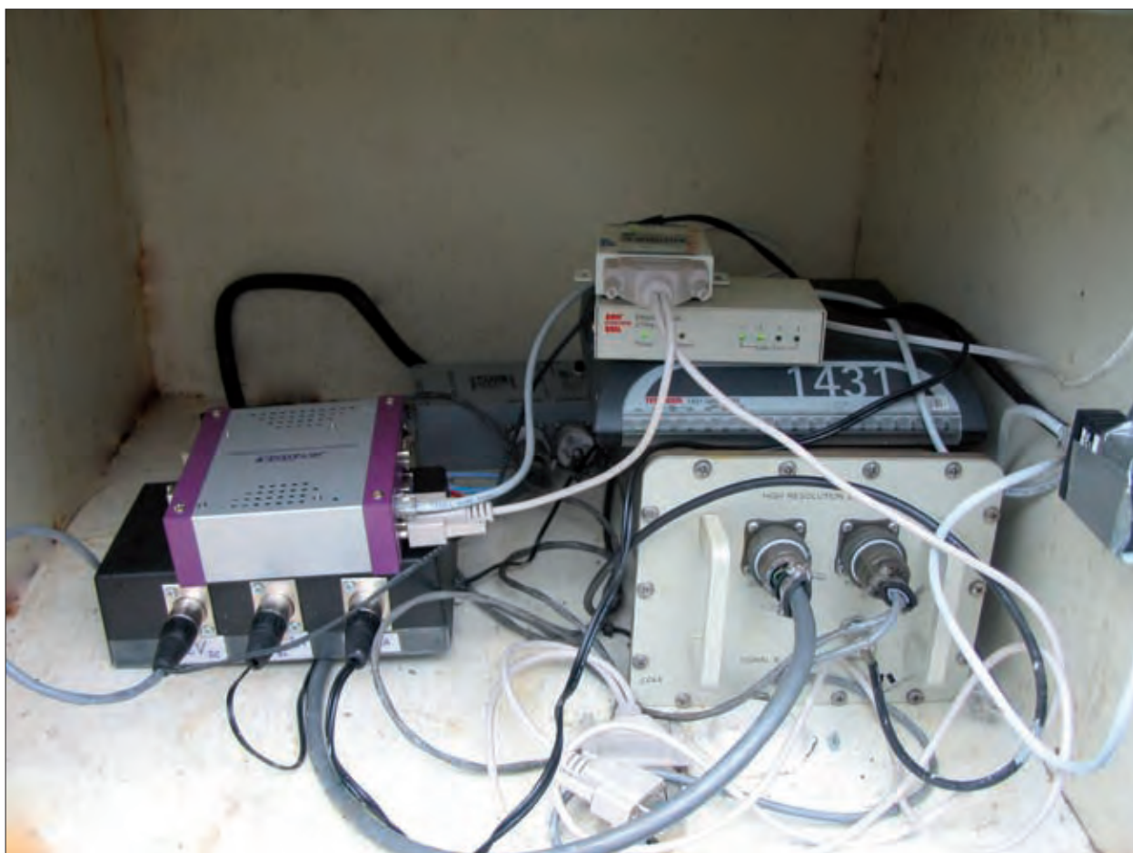
Slika 3. Dodatna pomnilniška enota, osnovana na industrijskem računalniku JetBox-8100, nameščena na potresni opazovalnici Cesta (CESS) (foto: I. Tasič)
