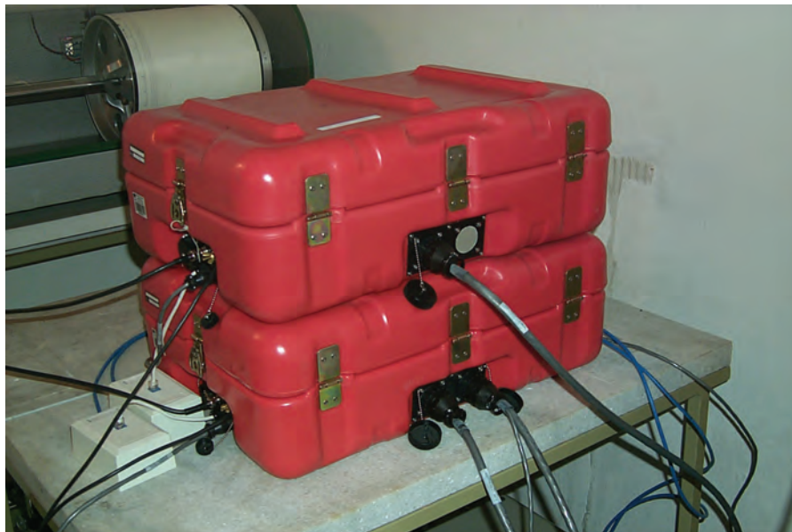
Slika 1: Zajemalna enota Quanterra Q730 (foto: Matjaž Gostinčar).
