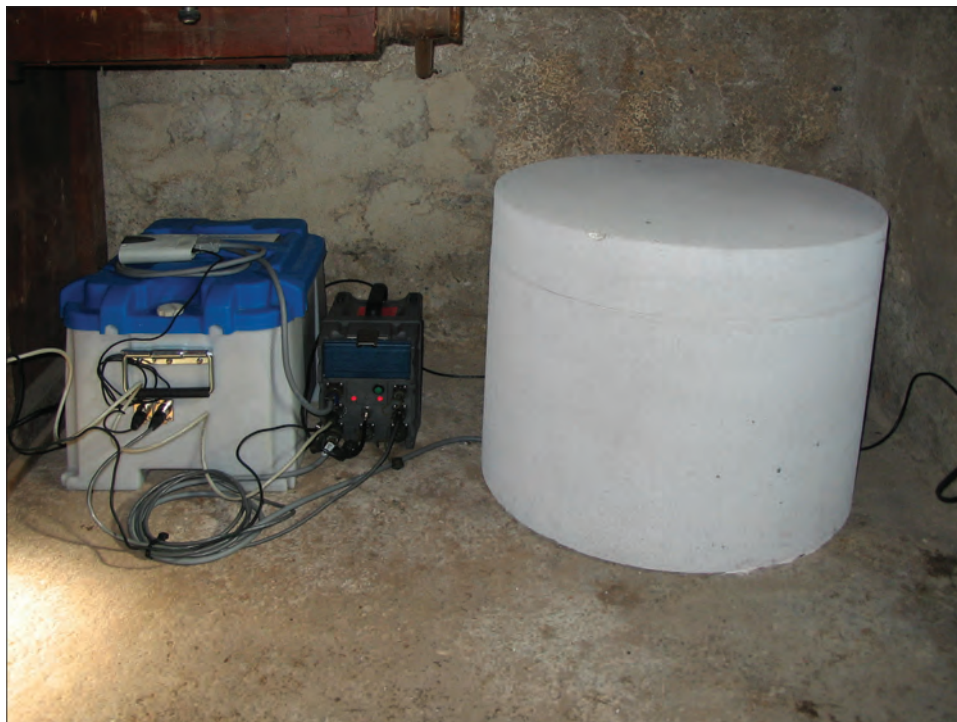
Slika 3: Namestitev inštrumentov potresne opazovalnice na Šmarjetni gori (foto: I. Tasič).
