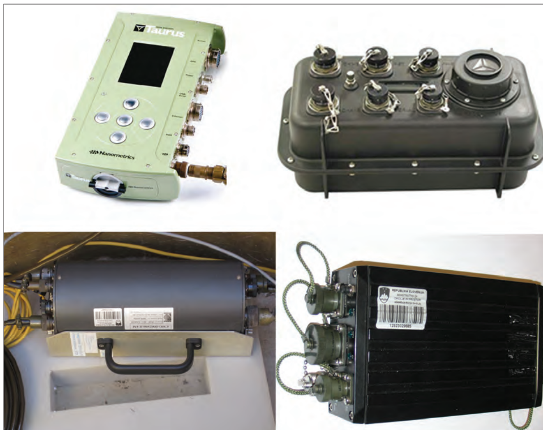
Slika 1: Zajemalne enote vključene v primerjalni test (levo zgoraj – Taurus; desno zgoraj – Reftek-130; levo spodaj – CMG-24EAM; desno spodaj – EDR-209).
