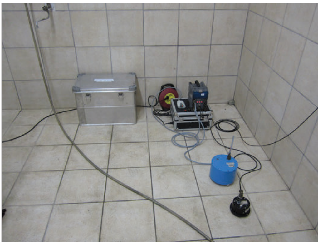
Slika 3: Namestitvev inštrumentov začasne potresne opazovalnice v Zdravstvenem domu v Senovem (foto: I. Tasič). Seizmološko opremo sestavljajo zajemalna enota tipa PR6, seizmometer tipa Lenartz-3D (modre barve) in pospeškometer tipa EpiSensor (črne barve).
