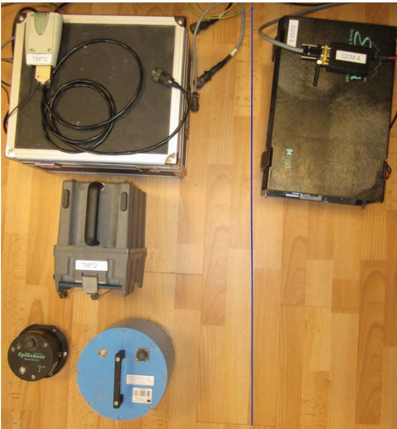
Slika 3: Primerjava seizmoloških sistemov PR6 (levo) in Etna (desno).
