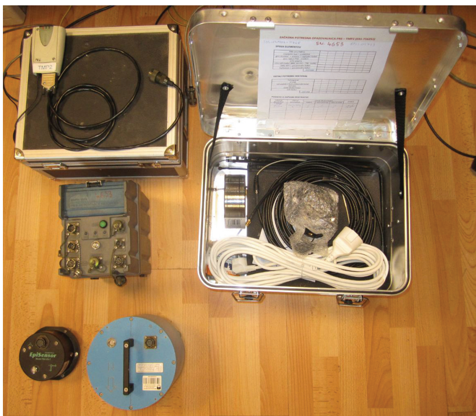
Slika 2: Seizmološki merilni sistem PR6-24, namenjen za začasne postavitve: pospeškometer tipa EpiSensor (levo spodaj), seizmometer tipa LE-3D/5s (spodaj levo, moder), zajemalna enota PR6-24 (levo sredina), napajalna enota (levo zgoraj) in transportna škatla z ostalo opremo (desno).
