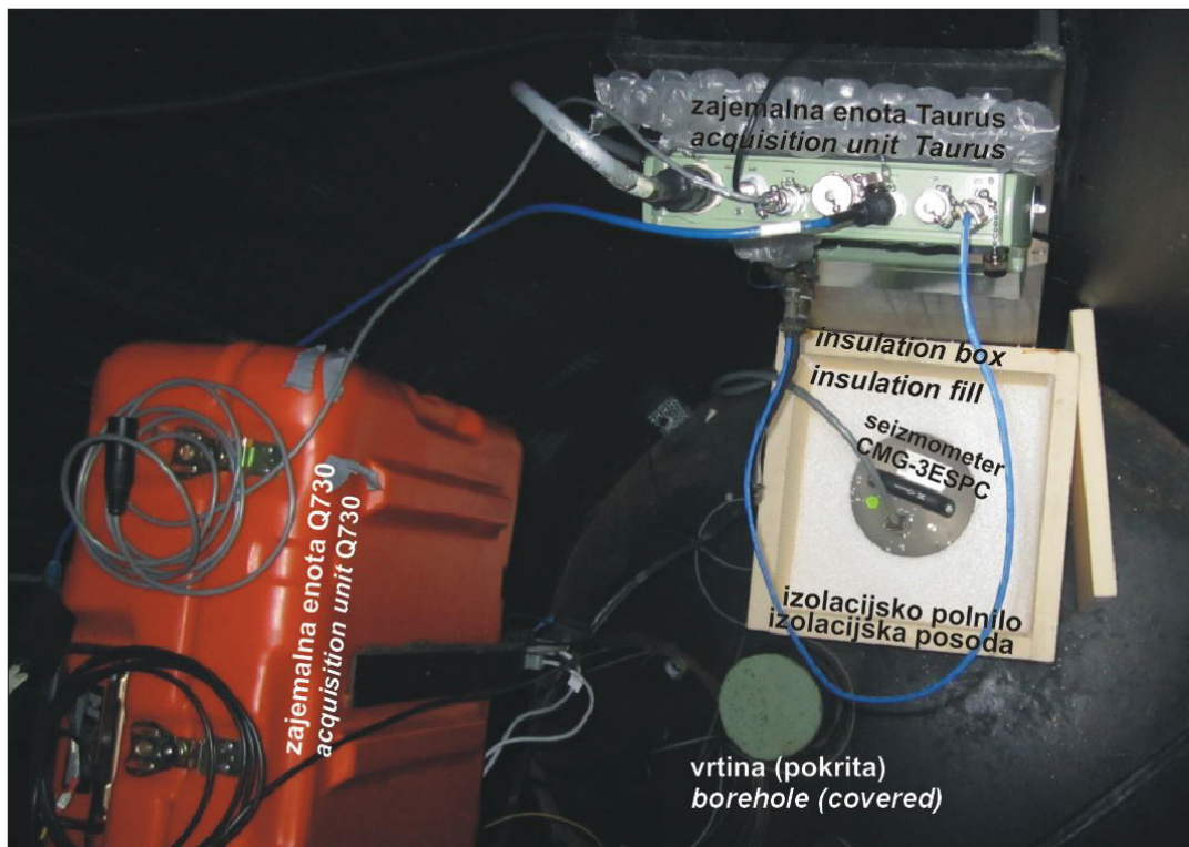
Slika 1.: Postavitve vzporednega merilnega sistema na potresni opazovalnici PDKS
