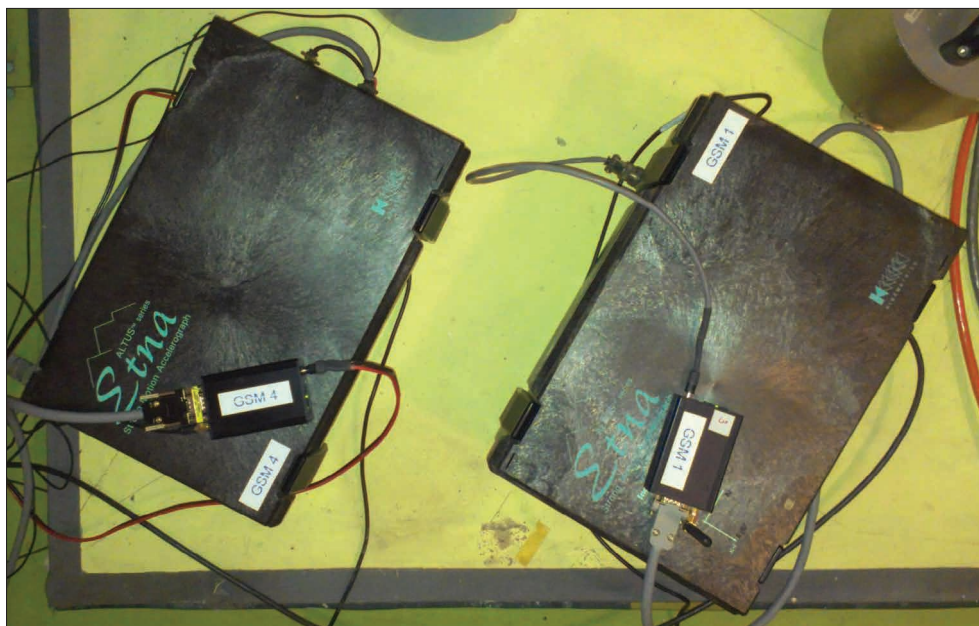
Slika 1: Seizmološka merilna sistema Etna, namenjena za začasne postavitve Figure 1: Two seismological systems Etna, intended for temporary deployment.
