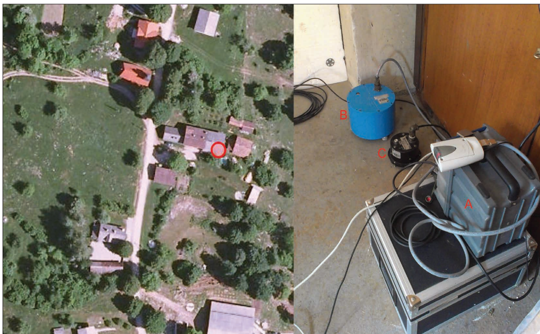
Slika 3: Lokacija začasne potresne opazovalnice v stanovanjski hiši v Seču (zgoraj levo). Seizmološko opremo (zgoraj desno) sestavljajo zajemalna enota tipa Earth Data PR6-24 (A), seizmometer tipa Lennartz-3D/5s (B) in pospeškometer tipa EpiSensor (C). (foto: I. Tasič)
