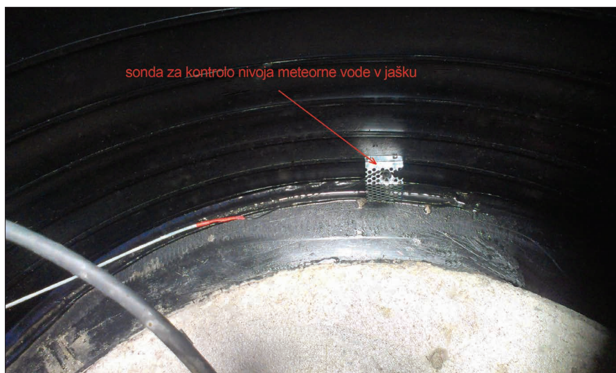
Slika 2: Sonda nadzornega sistema za kontrolo nivoja meteorne vode, ki lahko vdre v jašek ob večjem deževju. Sonde smo namestili v jaških na potresnih opazovalnicah BOJS, CADS, CRES, GBRs, GROS, LEGS, PERS in VISS. (foto: I. Tasič).
