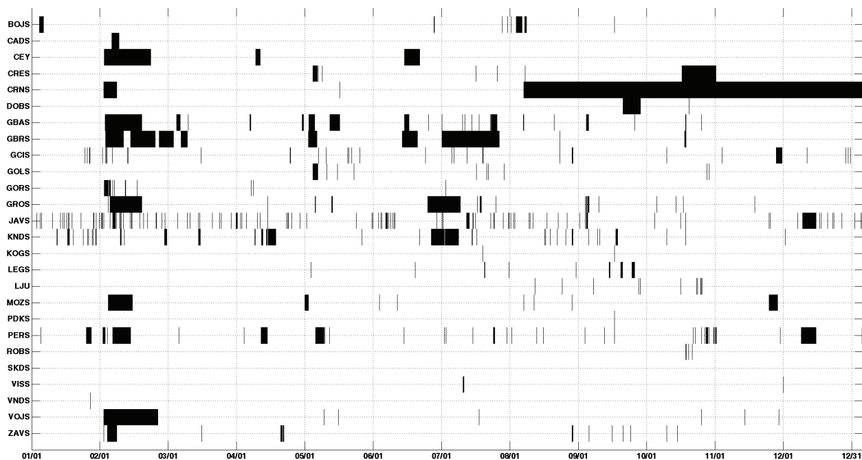
Slika 2: Pregled delovanja DMPO v letu 2014. Izpadi so označeni s črno barvo. Ločljivost slike omogoča, da so vidni le izpadi daljši od treh ur.
