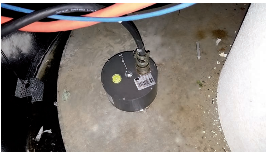
Slika 2: Namestitev akcelerometra CMG-5T v seizmičnem jašku na opazovalnici CADs. (foto: I. Tasič)
