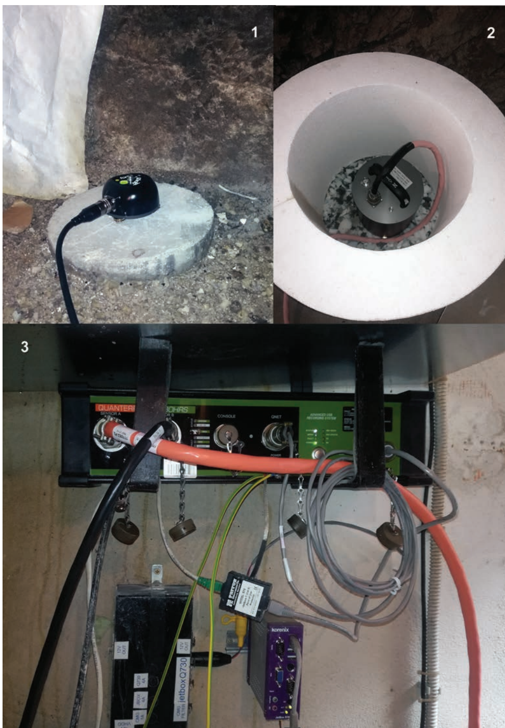
Slika 2: Na potresni opazovalnici Robič (ROBS) smo namestili novo 6-kanalno zajemalno enoto Quanterra Q330HR (3) na katero smo poleg seizmometra Güralp CMG-3ESP(2) priključili še akcelorometer Güralp Fortis (1) (foto: Luka Pančur)
