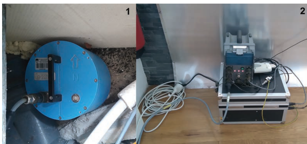
Slika 3: Na začasnih opazovalnicah ZOPP in ZOSP v Zagorju je bil nameščen seizmometer Lenartz Le-3D-5s (1) in priključen na zajemalno enoto EarthData PR-6 (2) (foto: Marko Mali)
