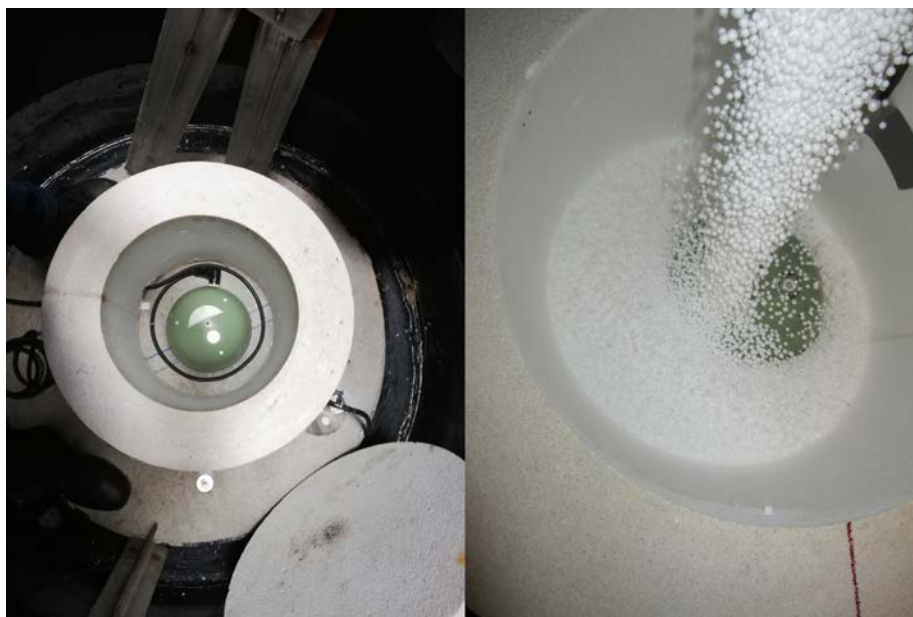
Slika 2: Namestitve novega seizmometra Trillium v stiroporno ohišje s stiropornimi kroglicami za toplotno izolacijo na potresni opazovalnici VOJS na Vojskem (foto: M. Mali).
